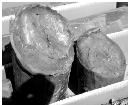
Fotografía 3: Superficie pulida en testigo de sondeo.
